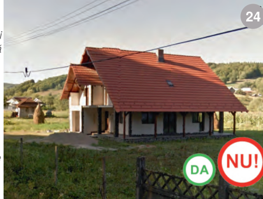
casă în Stoiceni- acoperișul e abrupt și e acoperit cu țigle ceramice- A A DA!- dar e în două ape, iar culoarea țiglei e prea tare- A A NU!
