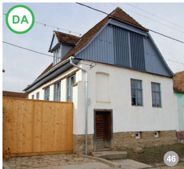
A A DA: casă în Cobor/ Brașov. Deși arhitectura sa aparține unei alte zone etnografice, e de reținut modul de rezolvare a iluminatului podului prin timpan
