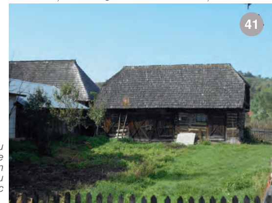
șură cu acoperiș în patru ape din Aspra- se observă evazarea acoperișului peste poarta carului, după modelul șurilor "cu gârbe" din zona Meseșului
